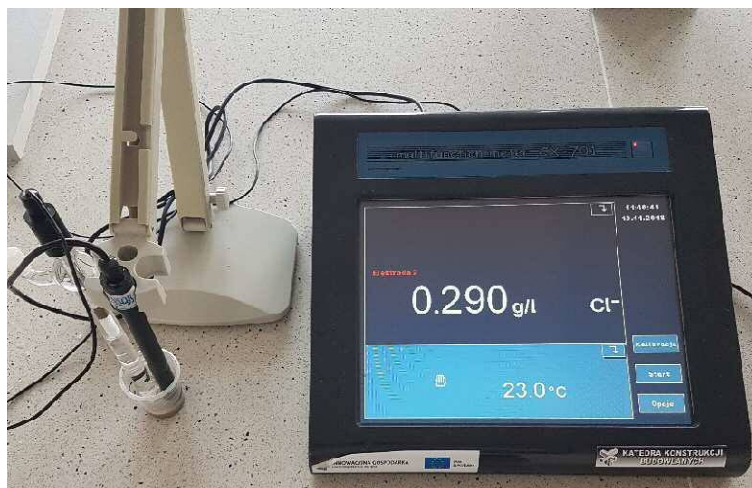
Fot. Z1-1. Pomiar stężenia chlorków w roztworach modelujących ciecz porową betonu wielofunkcyjnym multimetrem za pomocą elektrody jonoselektywnej
