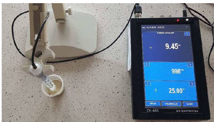
Fot. Z1-2. Pomiar pH w roztworach modelujących ciecz porową betonu
